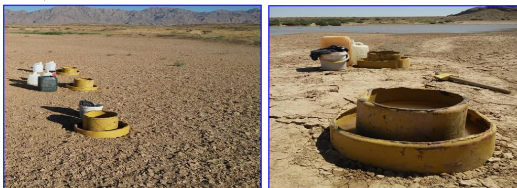
شکل ۲- آزمایش استوانه های مضاعف در مخازن بندهای خاکی
